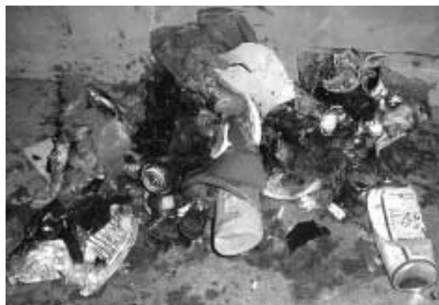
破碎処理時に残留ガスに引火して火災となったものの燃え殻
