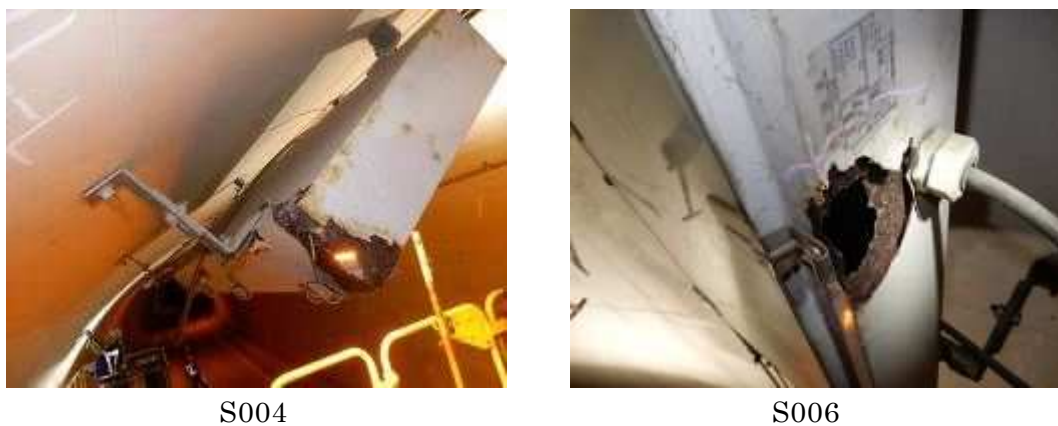
写真 4.4 孔食が確認されたトンネル照明
